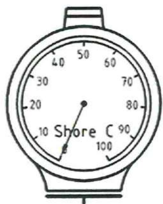
Рисунок Б.1 — Схема прибора для измерения твердости (шкала С по Шору)
